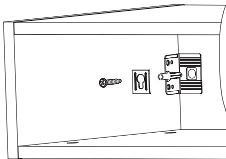
Предварительно просверлить отверстия диаметром 5 мм в задней стенке тумбы.
