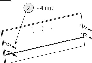
Ручка скоба: досверлить отв. 1 сверлом d=5 мм,
