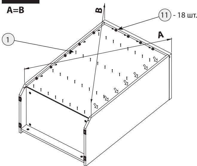
Проверить длину диагоналей, **A=B**. Прибить гвоздями заднюю стенку к стенке нижней и закрепить ее в пазах стенок боковых и крышки фиксаторами задней стенки.
