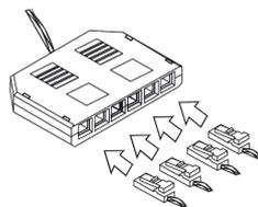
**Не допускается** подключение к блоку питания нагрузки большей мощности, чем та которая указана в паспорте блока питания. В один блок питания можно подключить не более 2-х шкафов, или 3-х метров светодиодной ленты (мощность ленты 9,6 Вт/м).
