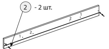
Ручка скоба: досверлить отв. 1 и 2 сверлом  $d=5$  мм,
