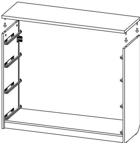
После соединения эксцентрики закрутить по часовой стрелке до упора.
