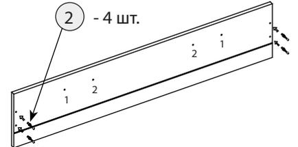
Ручка скоба: досверлить отв. 1 и 2 сверлом  $d=5$  мм,
