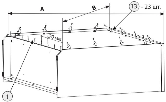
Проверить длину диагоналей,  $A=B$ . Прибить гвоздями заднюю стенку к стенке нижней и закрепить ее в пазах стенок боковых и крышки фиксаторами задней стенки.
