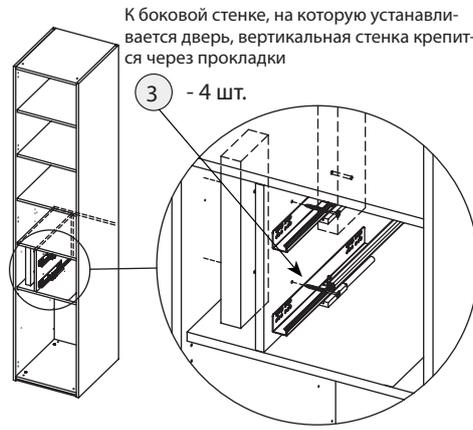
К боковой стенке, на которую устанавливается дверь, вертикальная стенка крепится через прокладки
