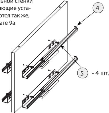
**Шаг 10** Установка стенки вертикальной. Для Тл1-22
