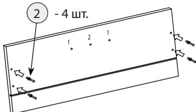
Ручка скоба: досверлить отв. 1 сверлом  $d=5$  мм, Ручка кнопка: досверлить отв. 2 сверлом  $d=5$  мм
