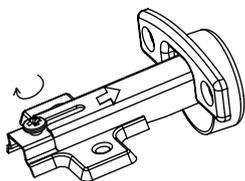
После установки зафиксировать при помощи винта.
