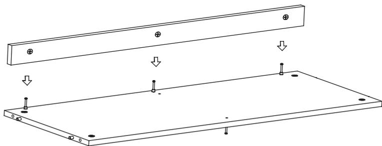
После соединения эксцентрики закрутить по часовой стрелке до упора.
