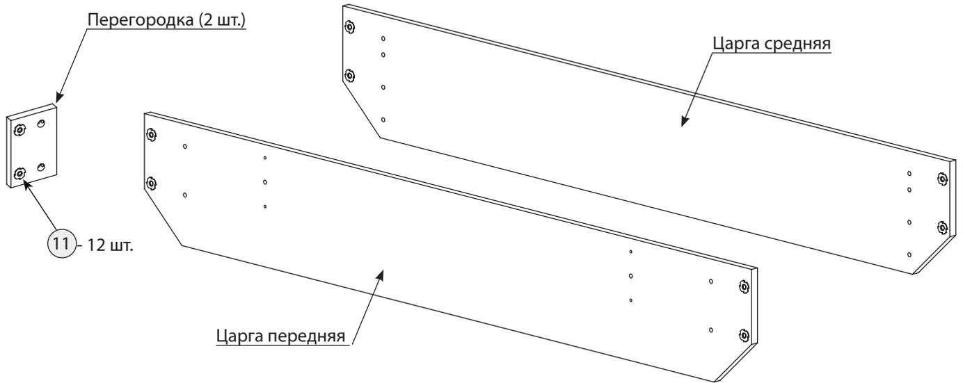
**Шаг 2** Собрать детали в указанном порядке (1...9). Для фиксации позиции 7 и дна подложить подпорки. **ВНИМАНИЕ!** Средняя царга должна быть установлена в строгом соответствии с рисунком (усовые гайки (11) расположены со стороны изножья). \*В Тл1-84 - одно ребро жесткости.
