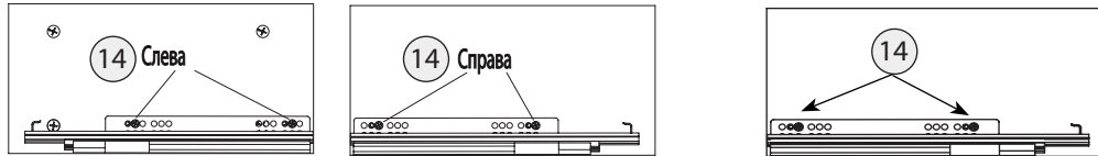
Схема крепления направляющих на перегородке
