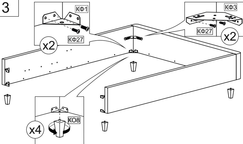
Сначала соедините фронтальную царгу с боковыми при помощи уголков. Большая угловая стяжка КФ3 крепится только к фронтальной царге на верхних отверстиях. Проследите за ровностью собранной конструкции.
