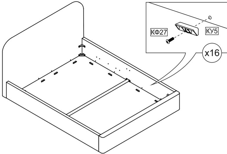
Упоры КУ5 для дна бельевого ящика можно установить до соединения царг и изголовья.
