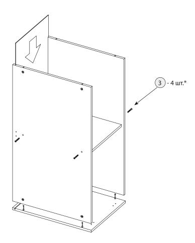
После соединения эксцентрики закрутить по часовой стрелке до упора.
