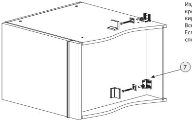
Изделие должно быть прикреплено к стене с помощью прилагаемого крепежа который подходит для крепления шкафа к стене из бетона или кирпича без пустот.
