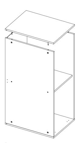
После соединения эксцентрики закрутить по часовой стрелке до упора.
