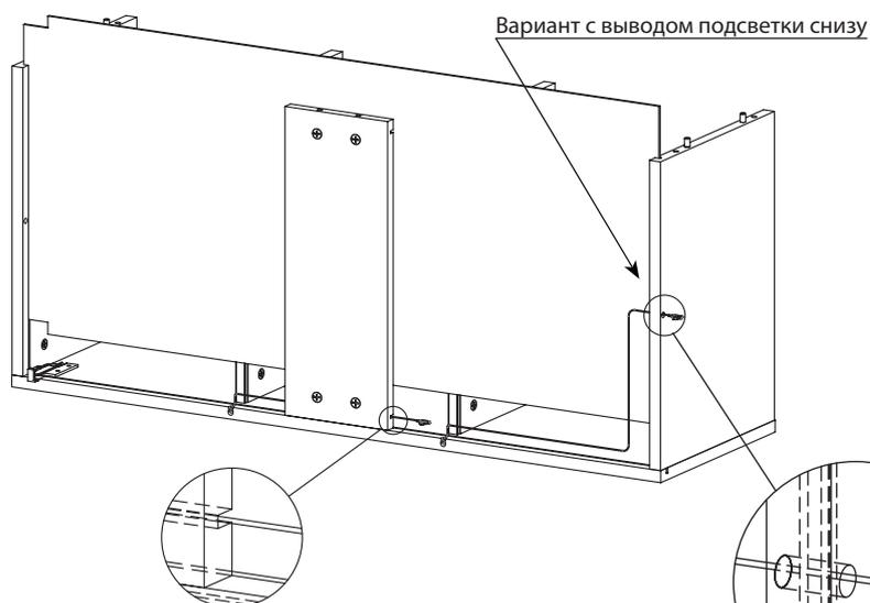
**Для Тл1-16С:** Один провод от подсветки должен оказаться в пазу ребра жесткости. Все провода пропустить сквозь отверстие для вывода проводов в крышке.
