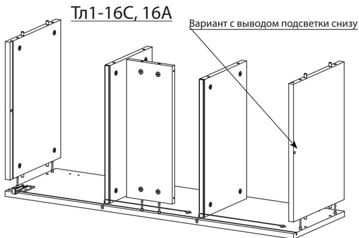
**Для Тл1-16С:** В зависимости от вывода проводов (вверх или вниз) установите крышку с заранее просверленным отверстием к навеске (вверх) или с противоположной стороны (вниз)
