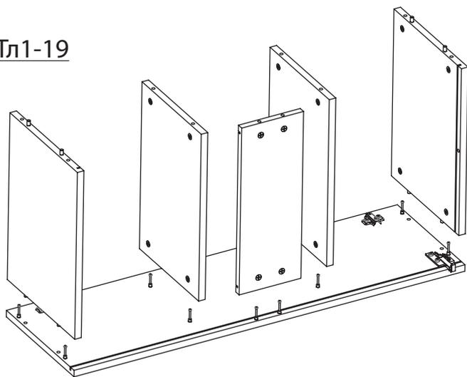
После соединения эксцентрики закрутить по часовой стрелке до упора.
