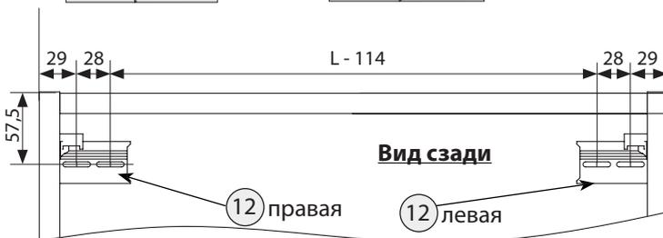
Просверлить отверстия диаметром 6 мм в стене по указанной схеме. В данные отверстия забить дюбели (16). С помощью шурупов закрепить ответные планки.
