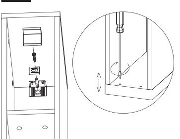
Изделие должно быть прикреплено к стене с помощью прилагаемого крепежа который подходит для крепления шкафа к стене из бетона или кирпича без пустот.
