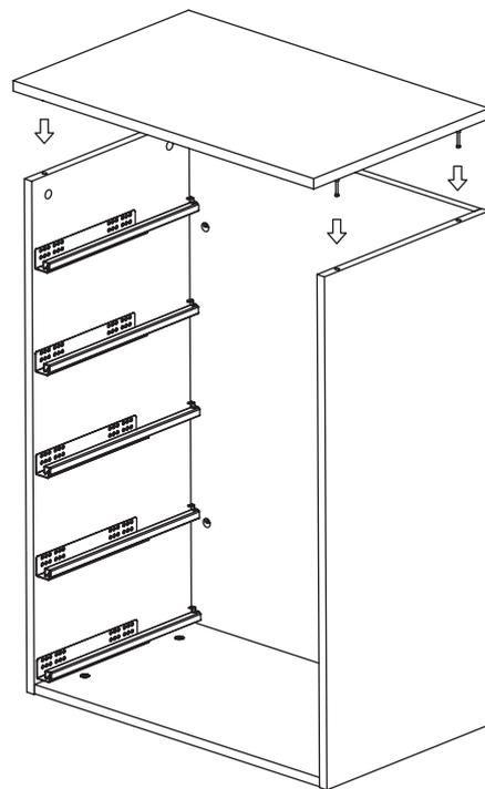
После соединения эксцентрики закрутить по часовой стрелке до упора.
