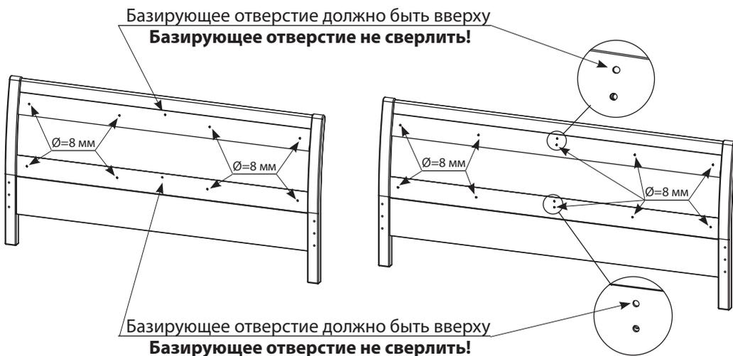
**Шаг 2** Закрепить мягкую вставку винтами через просверленные отверстия М4х15.
