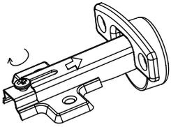
После установки зафиксировать при помощи винта.
