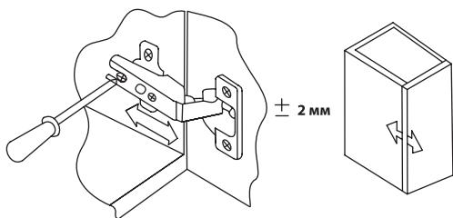
После установки зафиксировать при помощи винта.
