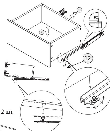
Регулировка ящика по высоте производится с помощью поворота регулировочного колесика (+3 мм)
