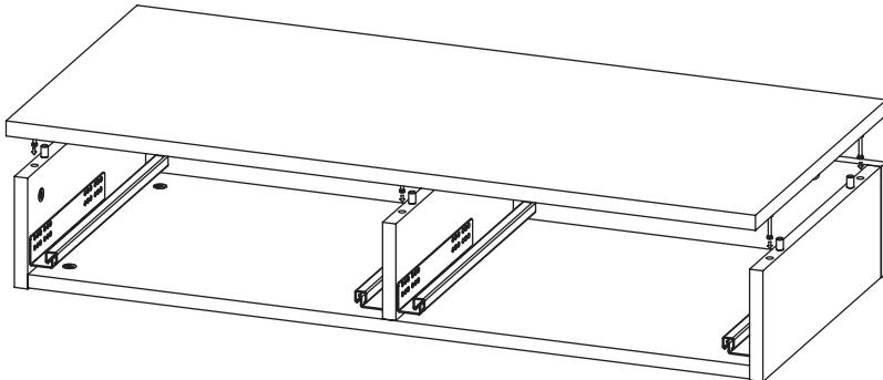
После соединения эксцентрики закрутить по часовой стрелке до упора.
